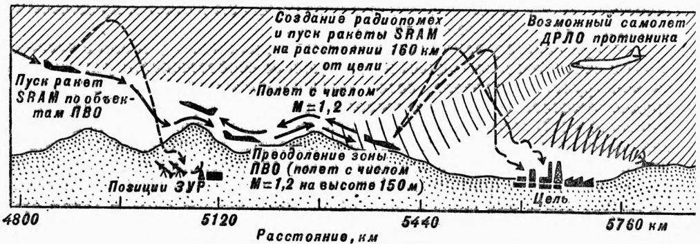
Рис. 3. Профиль боевого полета самолета FB-111 с ядерным оружием на объекты, расположенные в глубине территории противника (вверху). Профиль полета на последней тысяче километров маршрута при подходе к цели; на этом участке используется аппаратура самолетовождения по способу огибания рельефа местности.
